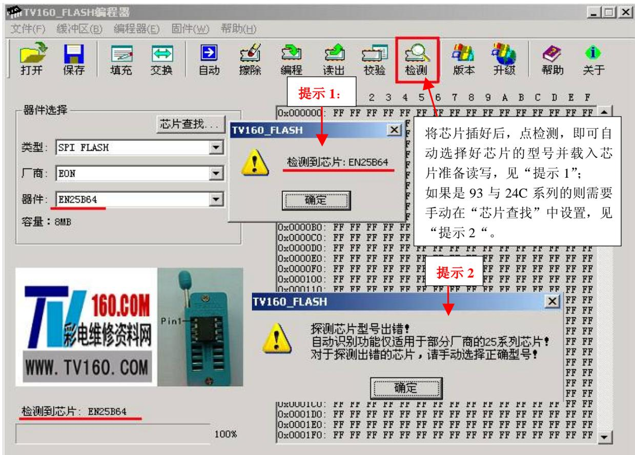
16. 芯片查找：手动设置芯片型号，对于一些自动检测时，检测不到的芯片，可以手动设置型号，如 24C 系列、93C 系列的存储器，需手动设置型号，如下图：点击“**芯片查找**”，将出现下列图片，输入芯片关键字即可，查找到正确芯片型号后，确定即可。
