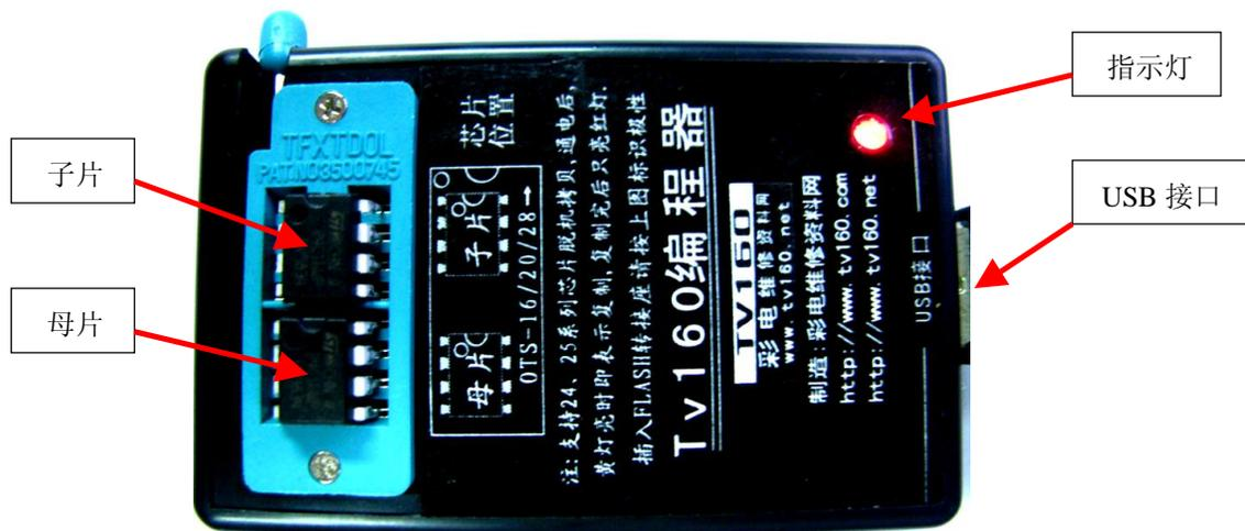
**指示灯:** 将编程器连接到电脑 USB 口, 或将编程器连接到稳压电源后, 红灯一直亮, 当编程器正在读、写、校验、擦除芯片时, 该指示灯亮黄色;
